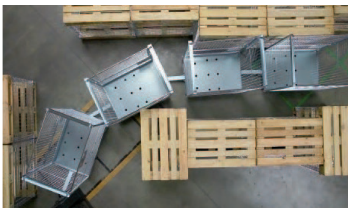
Kopírování trasy vozíkem s pevnou a řízenou nápravou.
