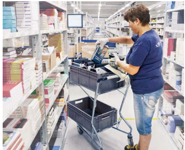
MASSANFERTIGUNG FÜR KNV LOGISTIK: Der stabile und gleichzeitig leichte Pick Trolley verfügt über zwei Ebenen zur Aufnahme von Kunststoffboxen. Ergonomisch wird nur in die obere Box kommissioniert, die Wanne auf der unteren Etage dient als Reserveplatz.
