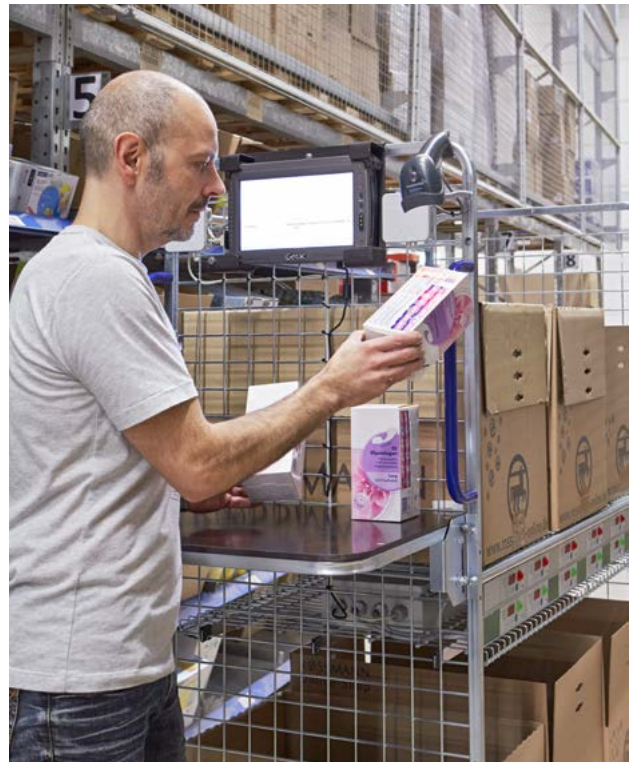
↑ ABKLAPPBARE HOLZ-/STAHEETAGE als Arbeitsfläche und als Sonderablage für schwere Produkte
