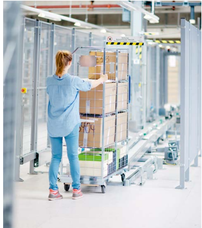
↑ DIE SPEZIELLE KONSTRUKTION DES UNTERGESTELLS ist kompatibel zu der vorhandenen automatisierten Förderanlage
