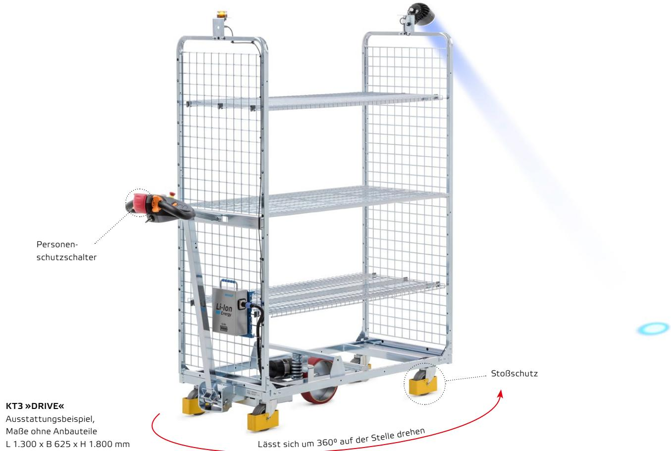
**Serienmäßige Ausstattung:** Untergestell aus Vierkanthrohr, inkl. Antistatikband. Seitenteile aus Vierkanthrohrrahmen mit Drahtgitter, in Untergestell eingesteckt und verschraubt. 1 Drahtetage oben, mit den Seitenteilen verschraubt. Starrer Griff mit Personenschutzschalter, Hupe und Geschwindigkeitsregulierung. 2 Grundstufen (max. 2,8 und 5,5 km/h),
