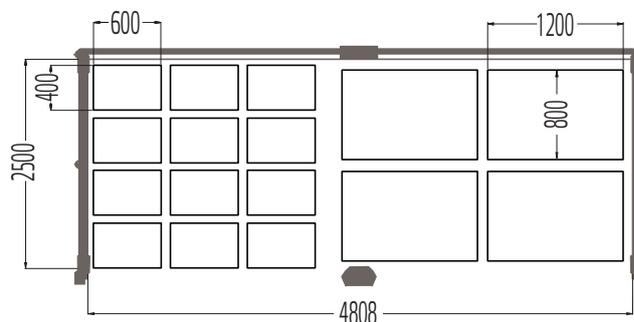
Esempio di progetto di una pratica disposizione di pallet (vista dall'alto)
