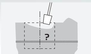
Informarsi se condutture di alimentazione sono in posa nel terreno.
