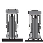
**Ruote per tappeti mobili tipo I** con due rondelle e due pattini frenanti.
