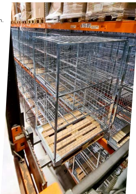
↑ PALETTENAUFsatz mit mehreren Einlegeböden
