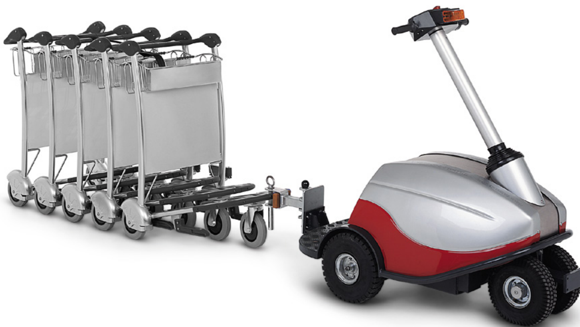
AIRPORT-SCOOTER avec adaptateur de traction
